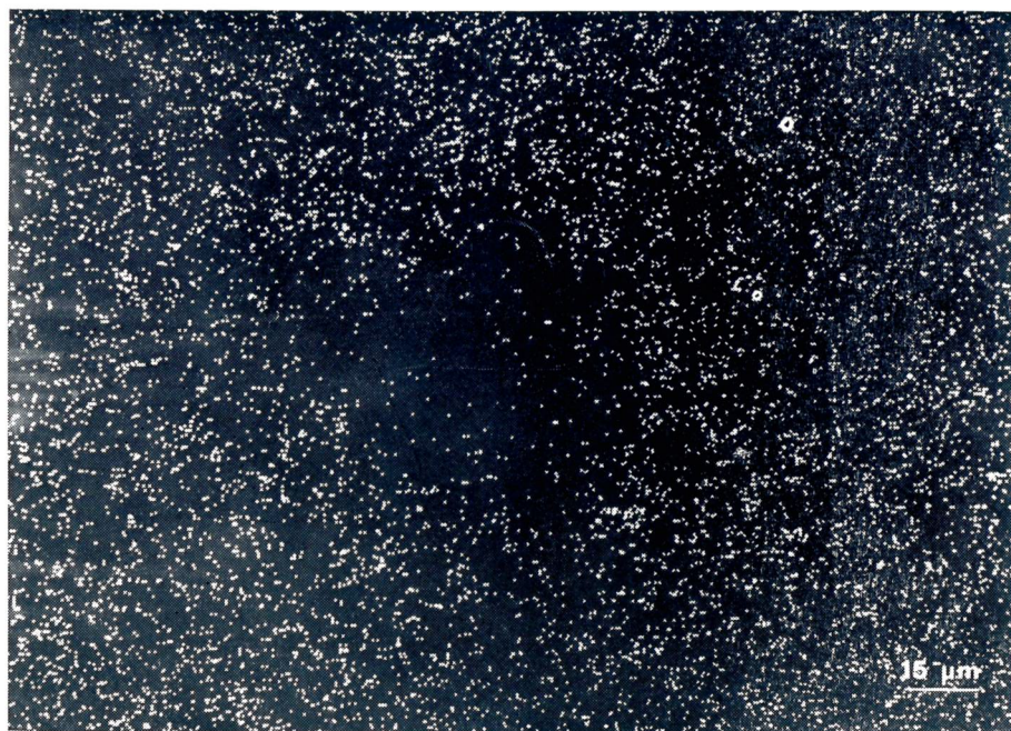
Fig. 5 — Mappa di distribuzione del Mg. Si nota una lacuna in corrispondenza dell'area più chiara.
